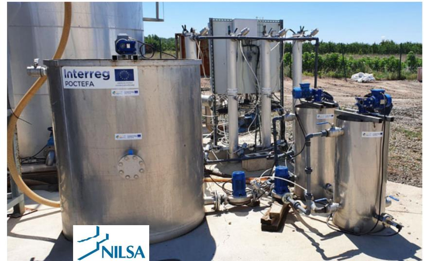
*Planta a escala piloto de fotocatalisis y adsorción con Carbón activo comercial*
